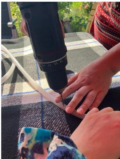
Abbildung 4: Bohrung der Löcher mit 3mm Bohrer (eigene Aufnahme)
