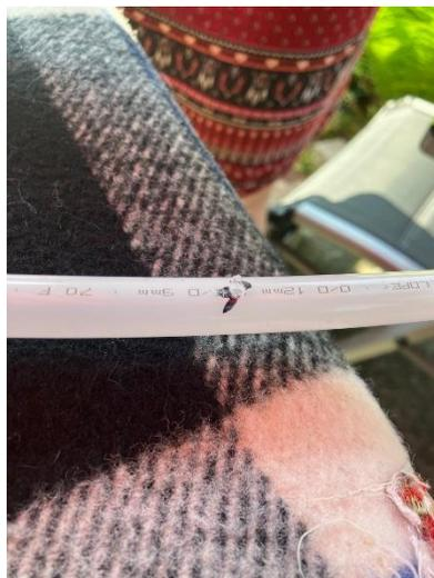
Abbildung 5: Gebohrtes Loch im Schlauch (eigene Aufnahme)
